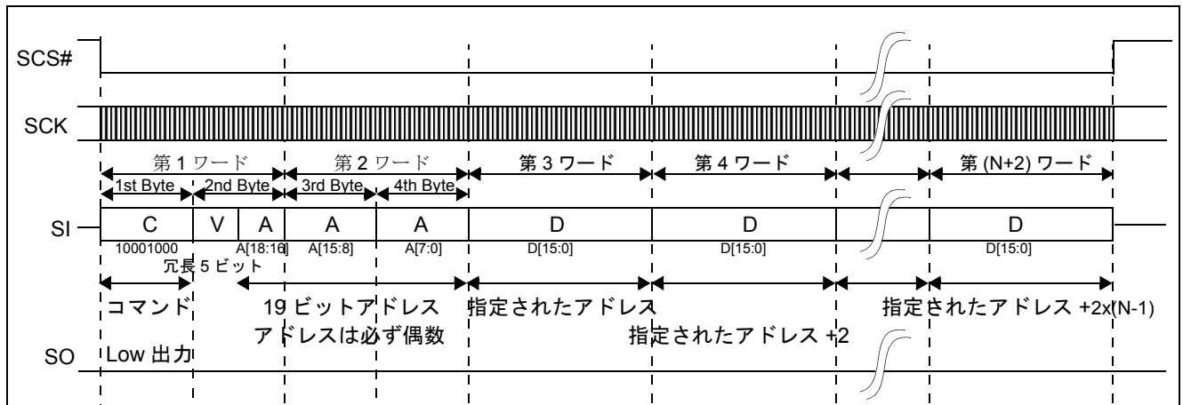
図 11-10: SPI16 ビットライトシーケンス例 ライト N ワード (N は 1 以上)
