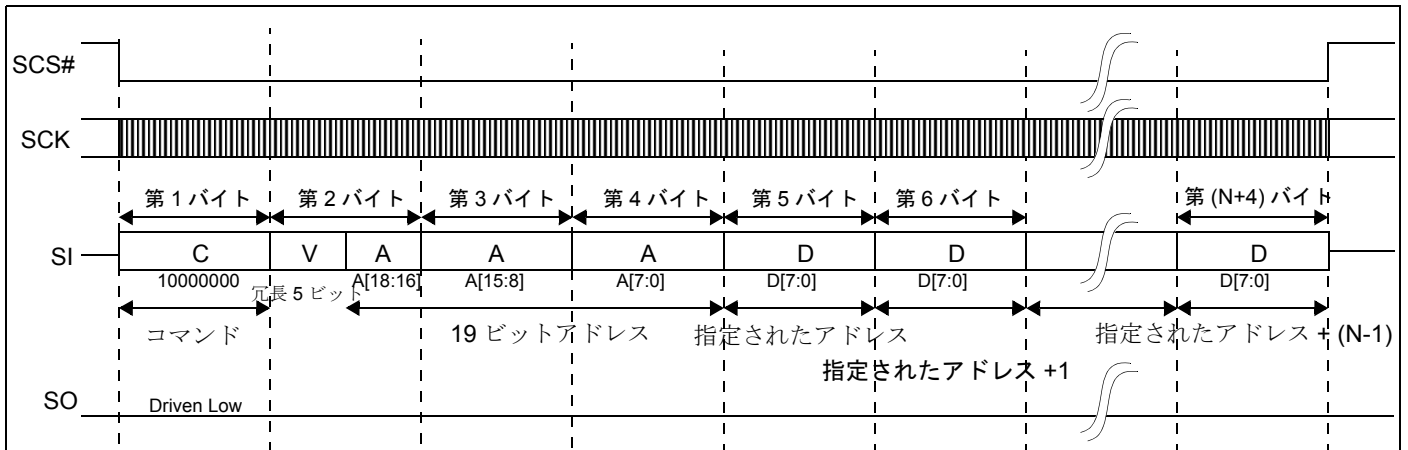
図 11-9: SPI8 ビットライトシーケンス例 ライト N バイト (N は 1 以上)
