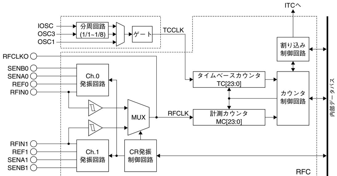
図21.1.1 R/F変換器の構成
