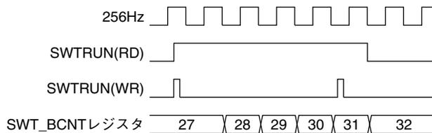
図12.5.2 Run/Stop制御のタイミングチャート
