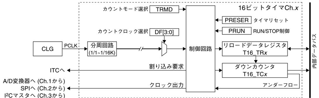
図9.1.1 T16モジュールの構成(1チャンネル)
