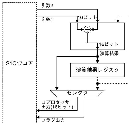
図24.4.1 除算モードのデータ経路
