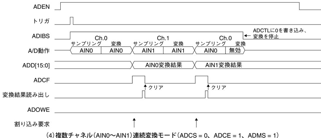
図20.4.5.1 A/D変換器の動作
