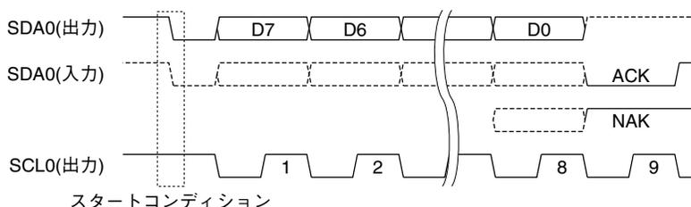
図16.5.3 ACKとNAK
