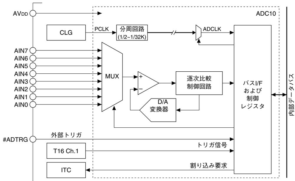
図20.1.1 A/D変換器の構成
