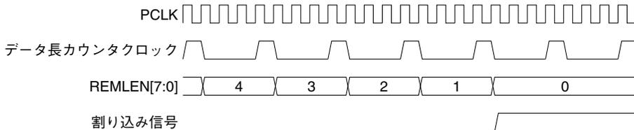
図18.5.2 アンダーフロー割り込み発生タイミング
