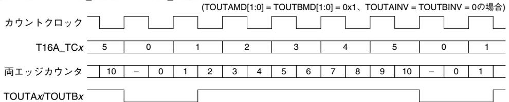
図10.6.4 ハーフクロックモードのPWM波形出力タイミング
