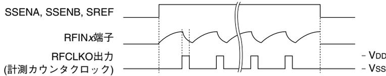
図21.4.3.1 CR発振クロック(RFCLK)波形
