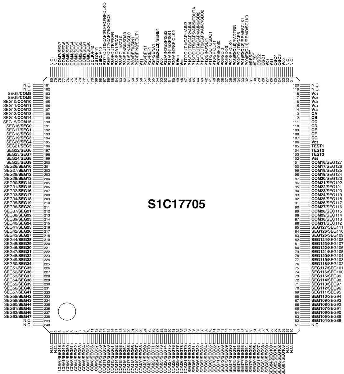
図1.3.1.1 S1C17705端子配置図(QFP23-240pin)
