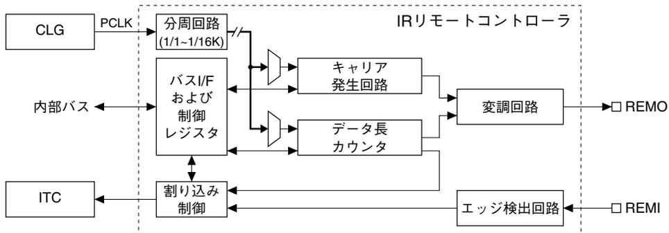
図18.1.1 REMCモジュールの構成
