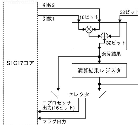
図24.5.2 積和演算モード時のデータ経路
