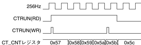
図11.4.2 Run/Stop制御のタイミングチャート
