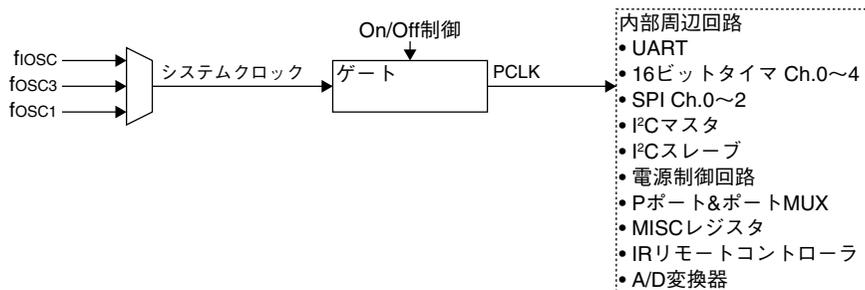
図7.6.1 周辺モジュールクロック制御回路
