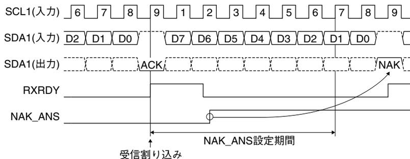
図17.5.3 NAK\_ANSの設定とNAK応答タイミング
