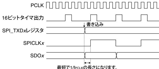
図15.5.1 CPHA = 0時のSDO<sub>x</sub>およびSPICLK<sub>x</sub>の変化タイミング
