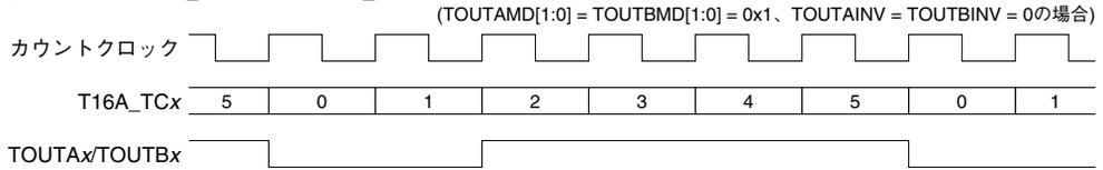
図10.6.3 ノーマルクロックモードのPWM波形出力タイミング
