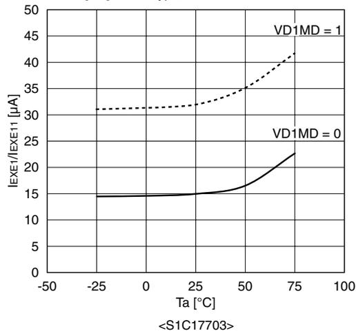
**OSC1+クロックギア動作時 消費電流対温度特性**
