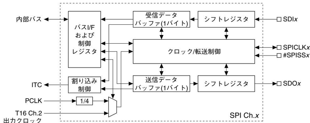
図15.1.1 SPIモジュールの構成(1チャンネル)
