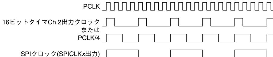
図15.3.1 マスターモードのSPIクロック
