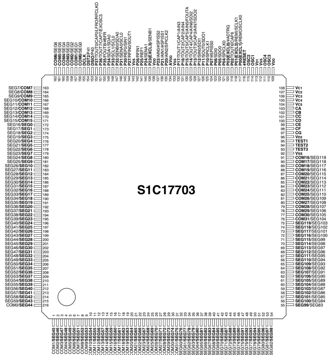
图1.3.2.1 S1C17703端子配置图(QFP21-216pin)
