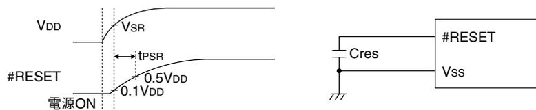
注: 電源をOFFにした後に再度パワーオンリセットを行う場合は、#RESET端子を $0.1V_{DD}$ 以下に落としてください。
