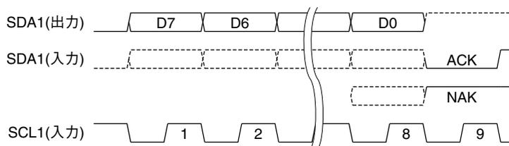
図17.5.2 ACKとNAK
