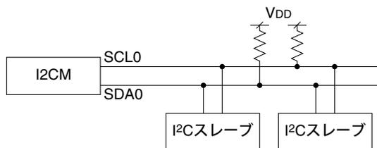
図16.2.1 I<sup>2</sup>Cの接続例
