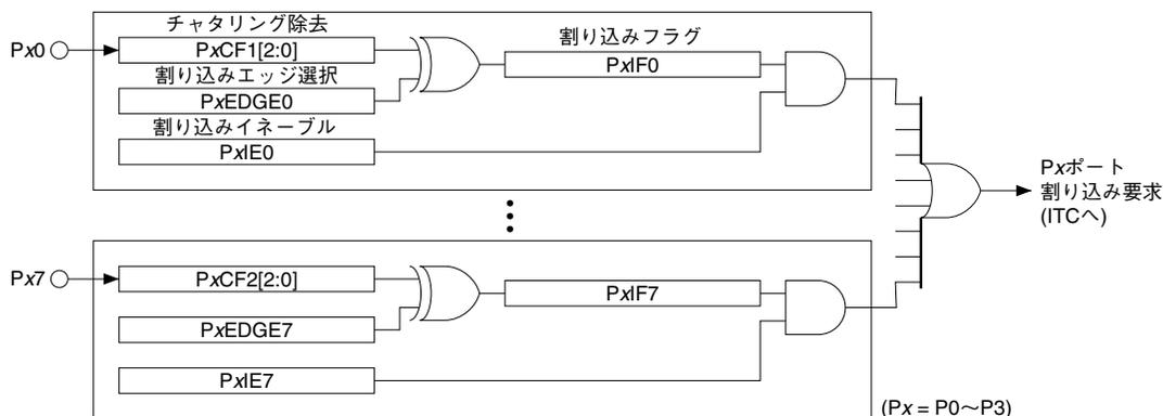
図8.7.1 ポート入力割り込み回路の構成
