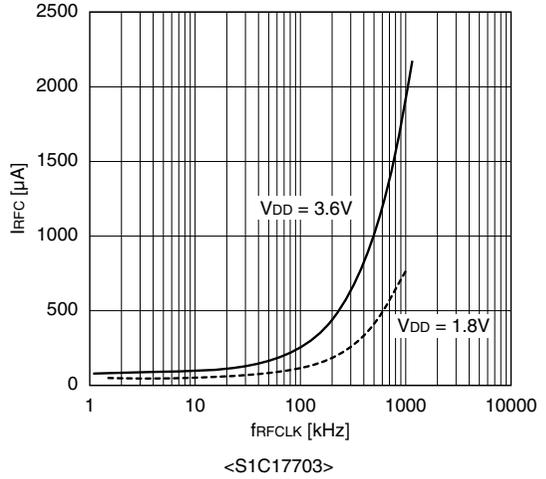
**RFC基準/センサ発振消費電流対周波数特性(容量性センサDC発振モード)**
