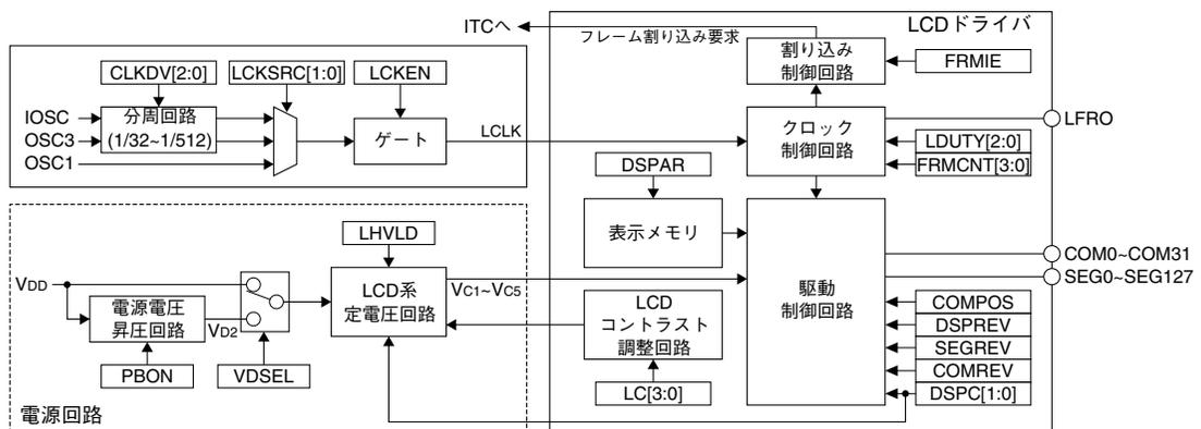
図19.1.1 LCDドライバと駆動電源の構成
