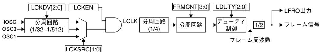
図19.4.1 LCDクロックシステム
