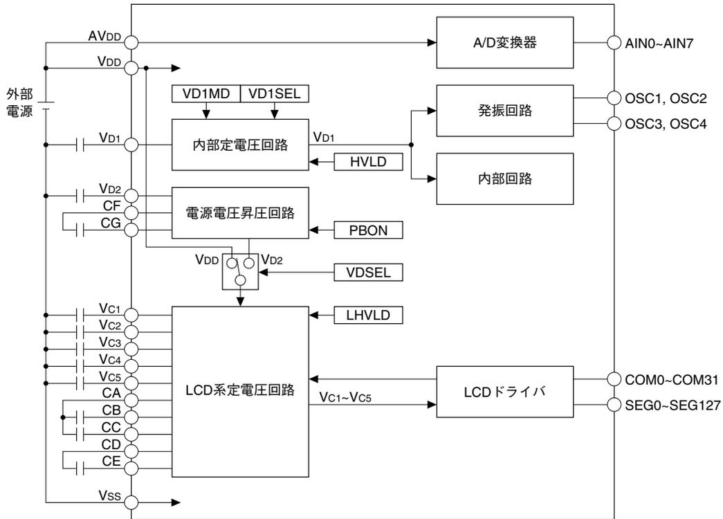
図4.3.1 電源回路の構成
