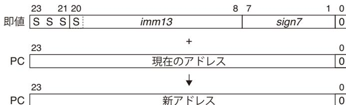
ext命令で拡張された即値の最上位ビット“S”が符号としてビット23～21に拡張され、21ビットの符号付きデータとなります。 $sign7$ の最上位ビットは符号ではなく、7ビットデータの最上位データとして扱われます。
