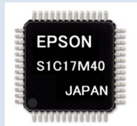
『S1C17M40』（パッケージタイプ：TQFP12-48pin）
