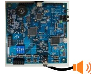
2. 再生モード2 :電磁ブザー(ボード搭載)+ディスクリート回路による音声再生
