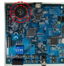
3. 再生モード3 :圧電ブザー(ご準備ください)+ディスクリート回路による音声再生
