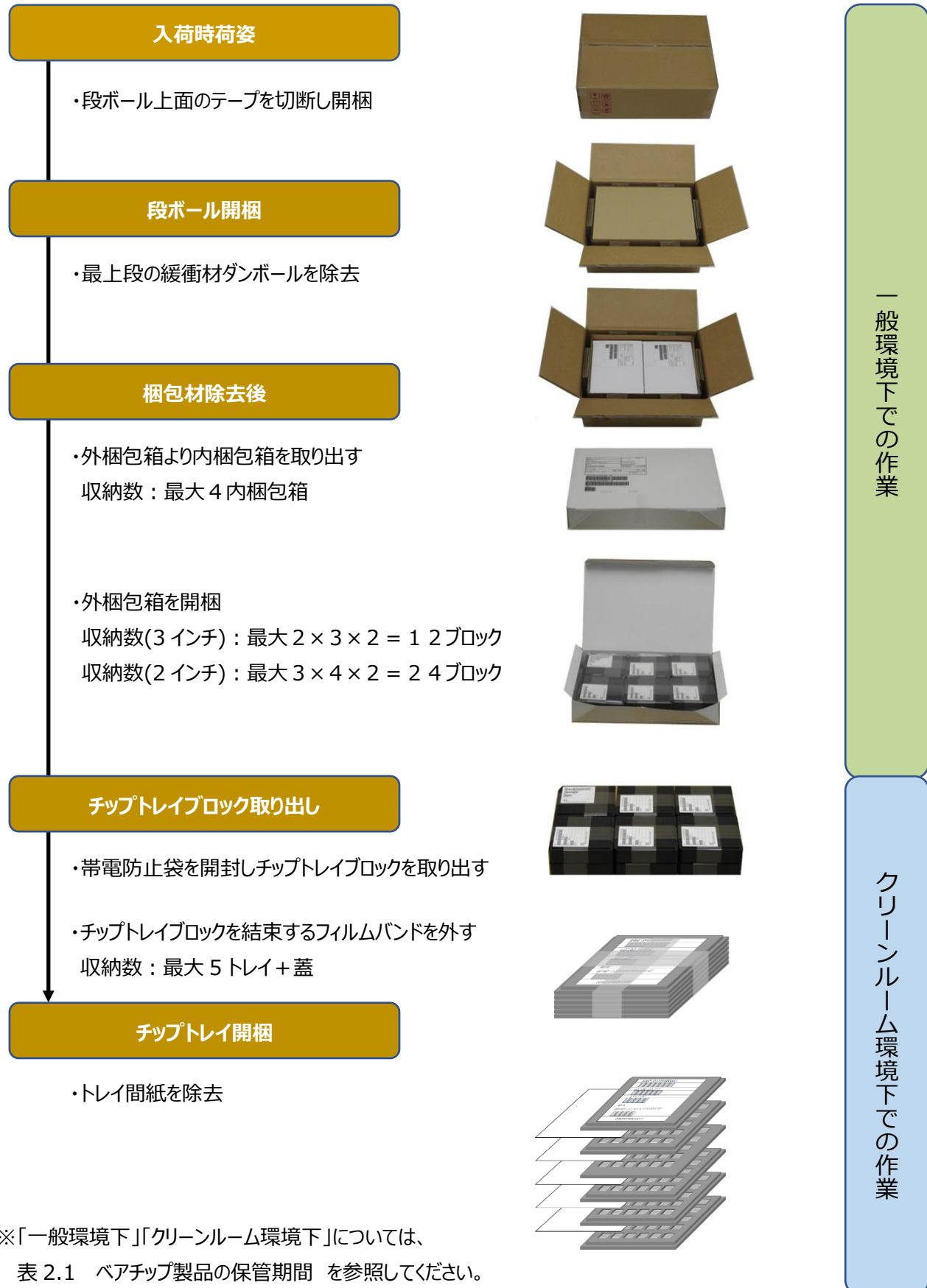
付図-2 ベアチップ製品の開梱手順（PS トレイ）
