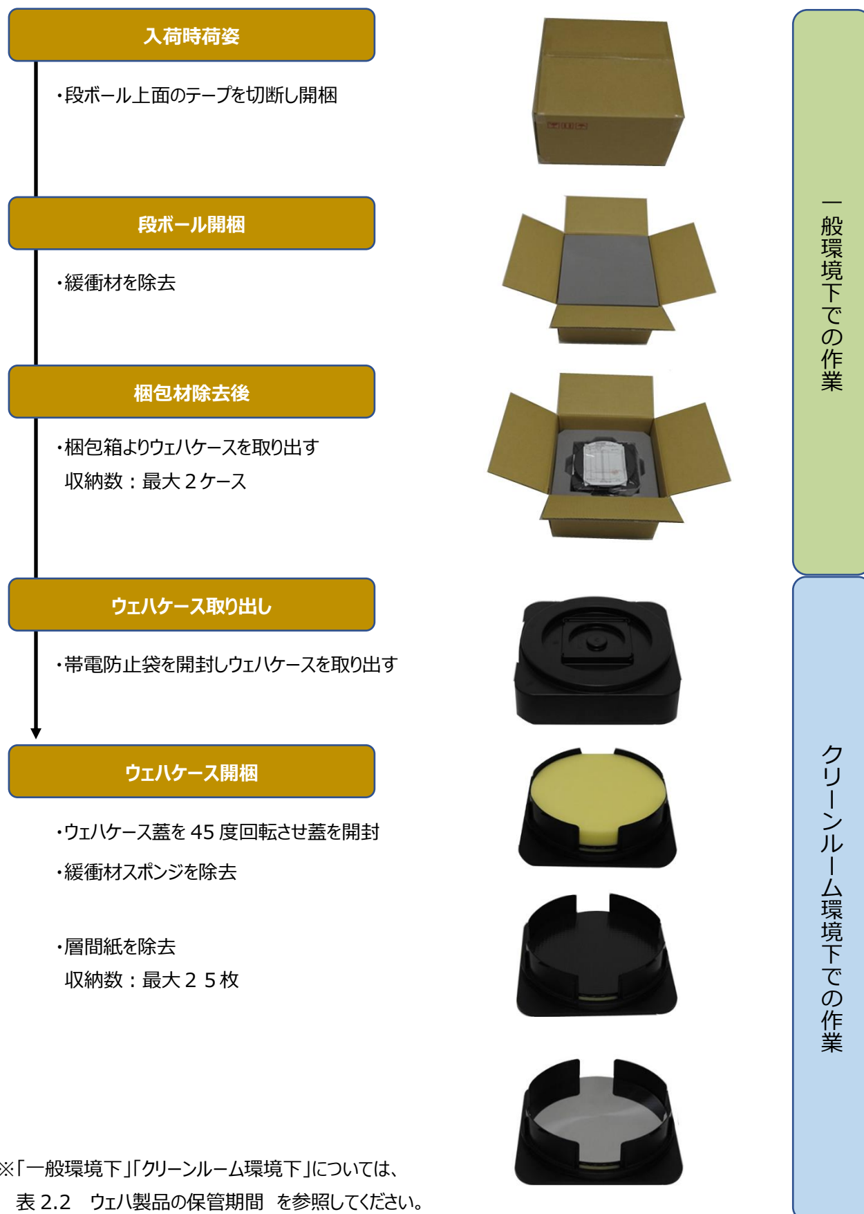
付図-2 ウェハ製品の開梱手順（ウェハケース）
