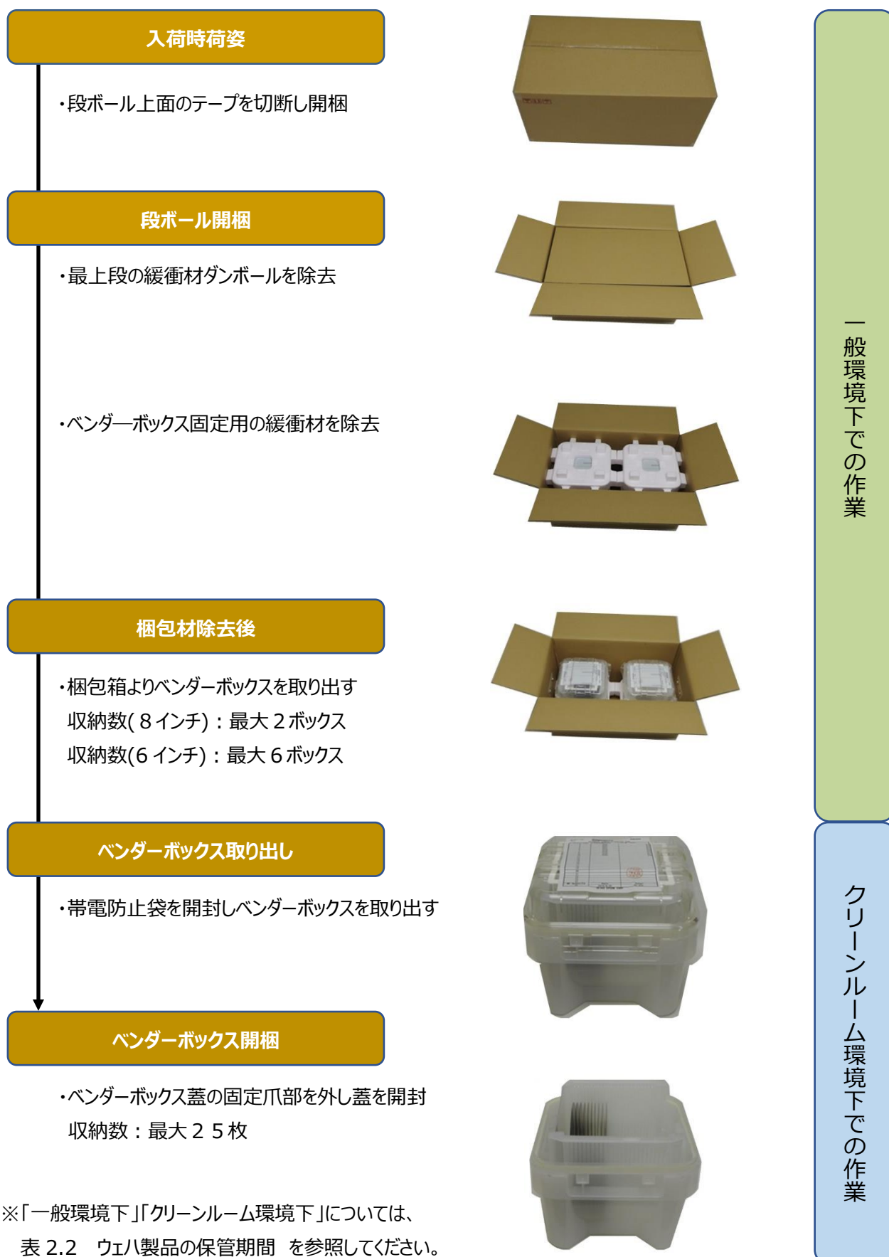
付図-1 ウェハ製品の開梱手順（バンダーボックス）
