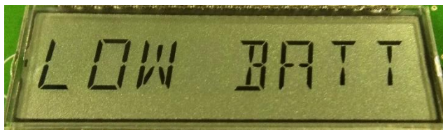
図 3.4-1 ローバッテリーモード中の LCD 表示
