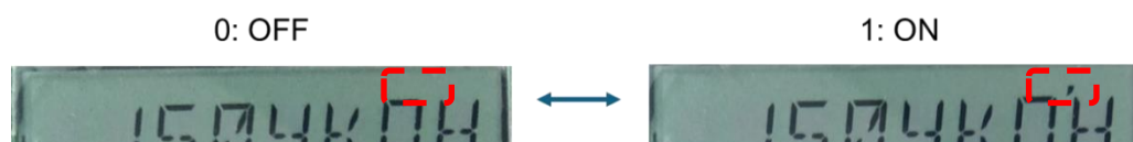
図 3.2.4-1 オートレンジ設定の切り替え時 LCD 表示
