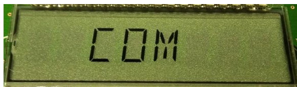
図 3.3-1 通信モード中の LCD 表示
