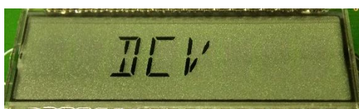
図 3.2.1-1 直流電圧測定に切り替え時の LCD 画面
