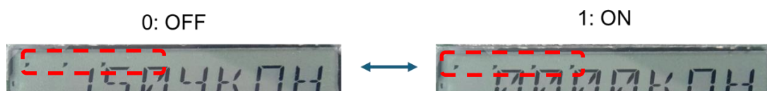
図 3.2.6-1 リラティブ設定の切り替え時 LCD 表示
