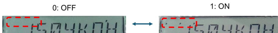
図 3.2.5-1 データホールド設定の切り替え時 LCD 表示
