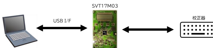
図 5.5.4-1 キャリブレーション用基準値測定時の接続図
