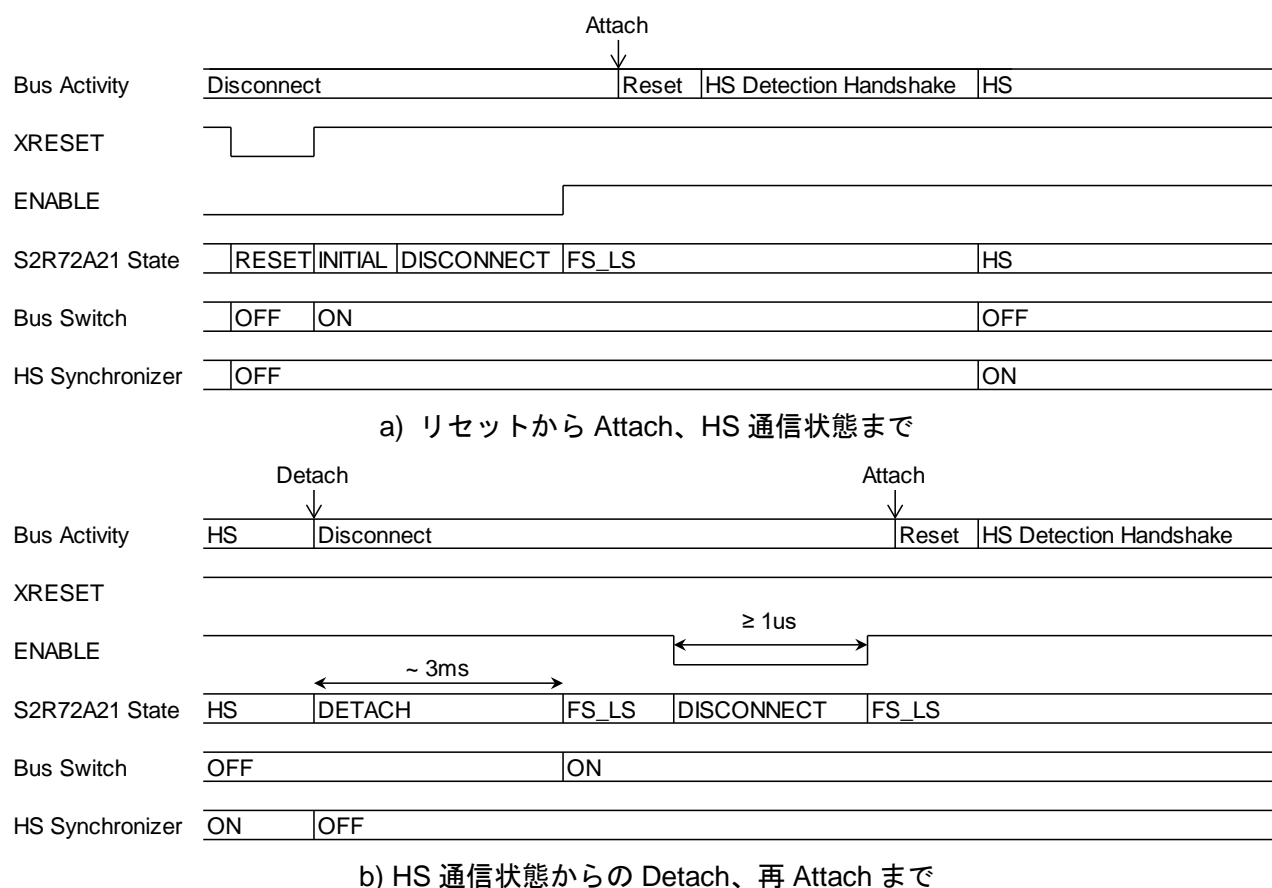
図 6.1.3.1.1 DETACH ステート有効かつ ENABLE 端子を制御する場合の動作の流れ
