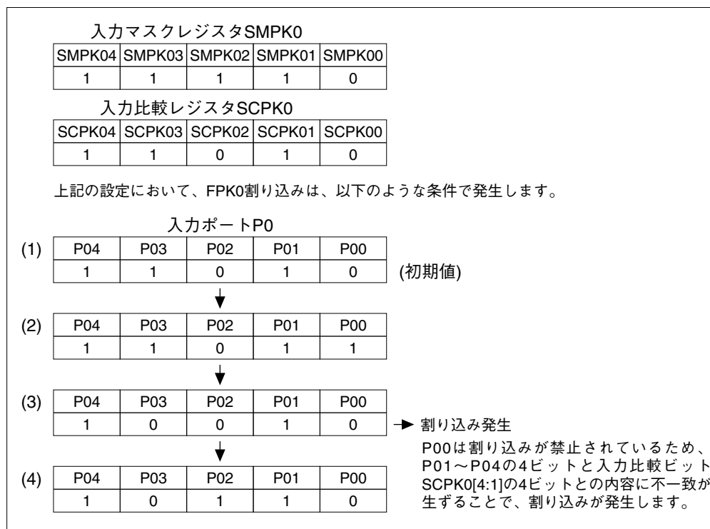
図VI.1.4.2.2 FPK0割り込み発生例 (SPPK0[2:0]でP0[4:0]が選択されている場合)
