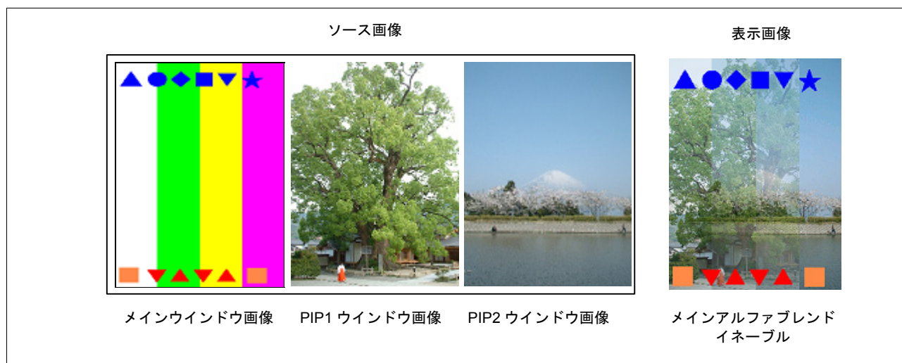
図12.17 メイン（最上層）、PIP1（中間層）およびPIP2（最下層）ウィンドウの表示例
