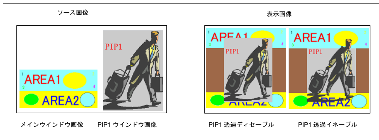
図12.13 PIP1（最上層）およびメイン（最下層）ウィンドウの表示例
