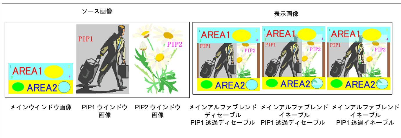
図12.16 メイン（最上層）、PIP1（中間層）およびPIP2（最下層）ウィンドウの表示例
