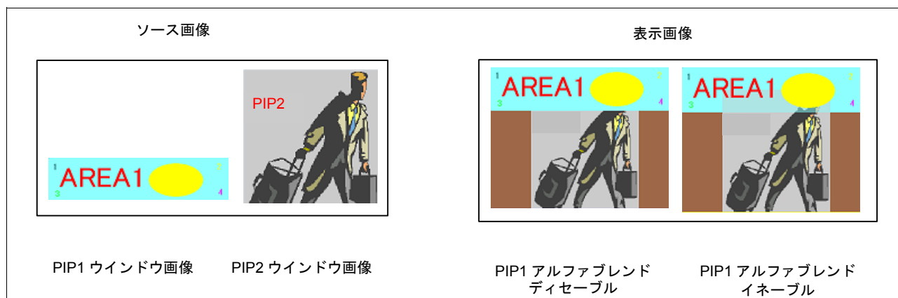
図12.22 PIP1（最上層）およびPIP2（最下層）ウインドウ表示例
