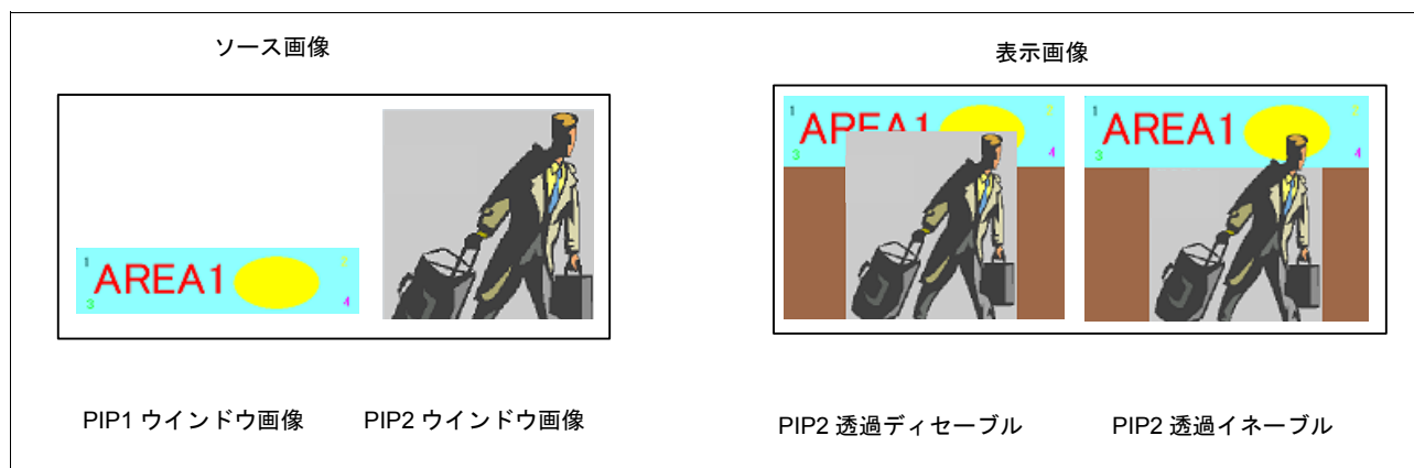
図12.23 PIP2（最上層）およびPIP1（最下層）ウィンドウの表示例
