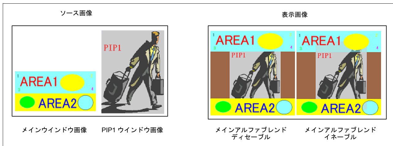
図12.12 メイン（最上層）およびPIP1（最下層）ウインドウの表示例
