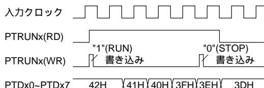
図5.2.1 RUN/STOP制御のタイミングチャート
