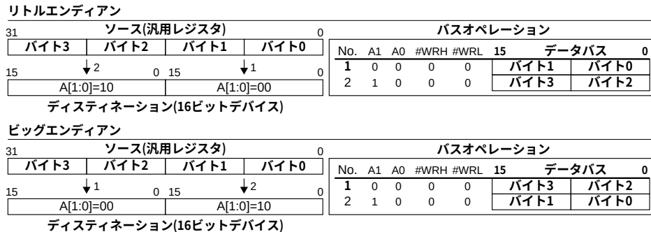
図4.7 16ビットデバイスへのワードデータ書き込み
