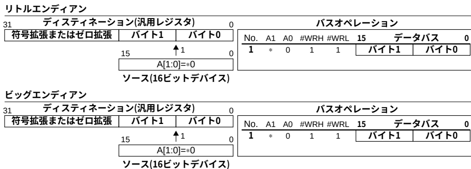
図4.10 16ビットデバイスからのハーフワードデータ読み込み
