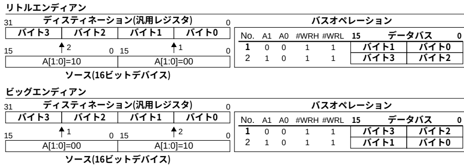
図4.8 16ビットデバイスからのワードデータ読み込み
