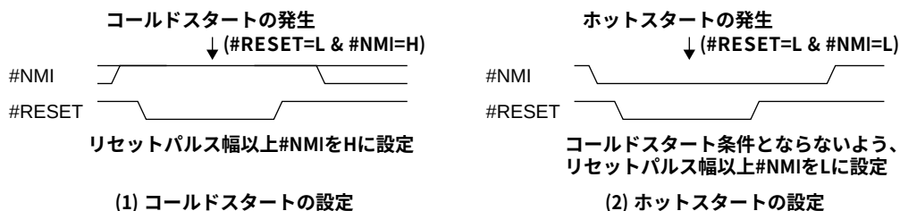
図3.1 #RESETと#NMIの端子設定
