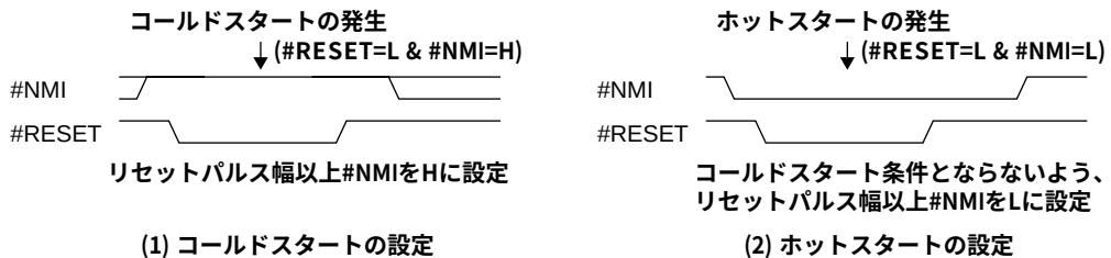
図3.1 #RESETと#NMIの端子設定
