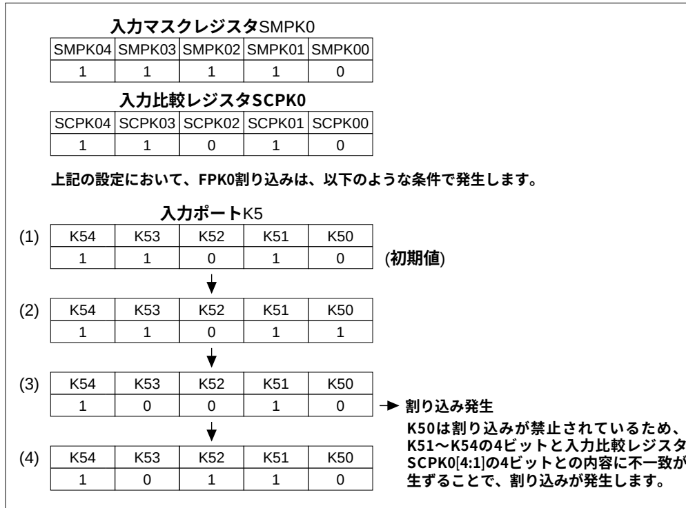
図9.5 FPK0割り込み発生例(SPPK[1:0]でK5[4:0]が選択されている場合)
