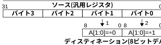
図4.15 8ビットデバイスへのハーフワードデータ書き込み
