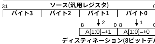
図4.14 8ビットデバイスからのワードデータ読み込み
