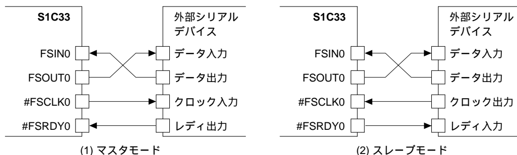
図III.10.3 クロック同期式マスタモードの接続例
