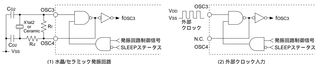
図II.6.2 高速( OSC3 )発振回路
