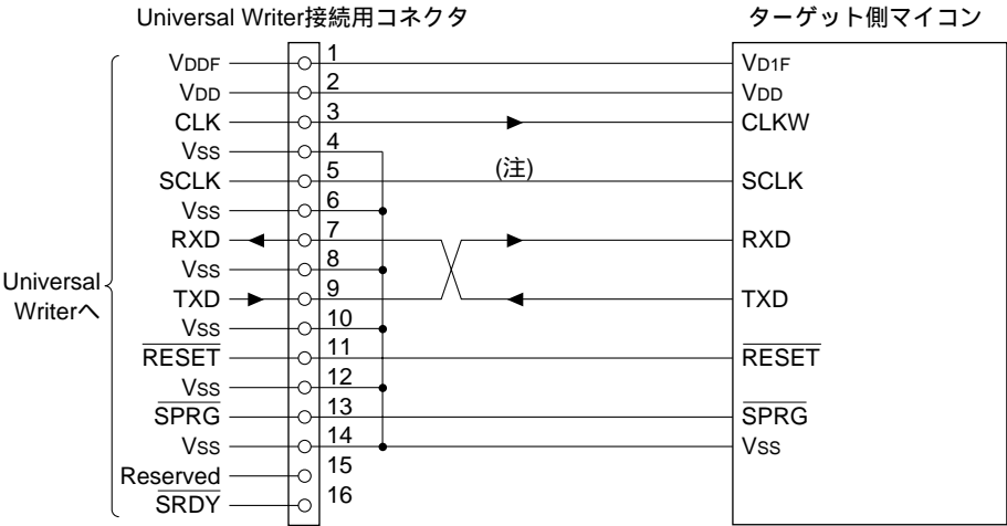
図A.3.4.1 オンボードプログラミング結線図
