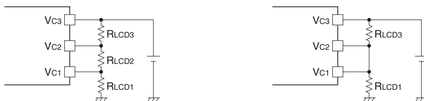
1/3バイアス選択時(LCD8DPWR.BIASSELビット = 1) 1/2バイアス選択時(LCD8DPWR.BIASSELビット = 0)
