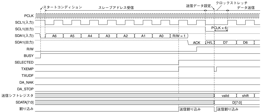
図21.5.5 I 2 Cスレーブタイミングチャート1(スタートコンディション→データ送信)
