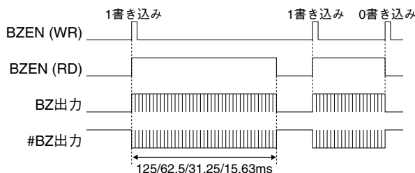
図20.5.3.1 1ショットモードのブザー出力
