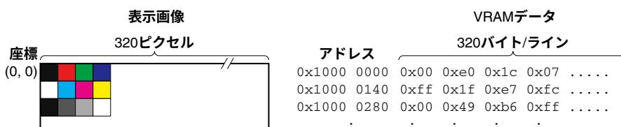
図26.5.5.8 8bppモードのVRAMデータ例
