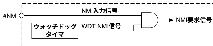
図5.2.1 NMI回路の構成
