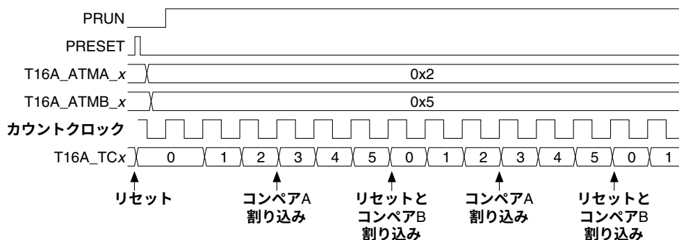
図15.5.4.1 コンパレータモード時動作タイミング
