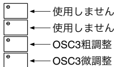
図B.1.1.2 CR発振周波数調整ボリューム
