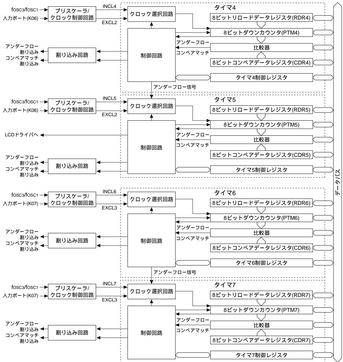
図5.10.1.2 16ビットプログラマブルタイマの構成(タイマ4～7)
