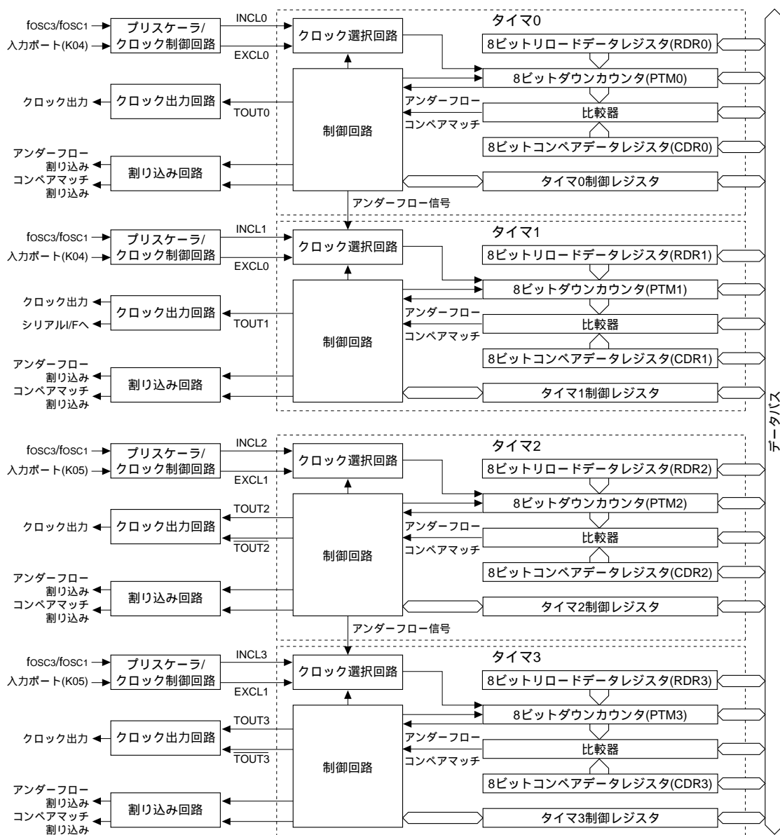
図5.10.1.1 16ビットプログラマブルタイマの構成(タイマ1～3)
