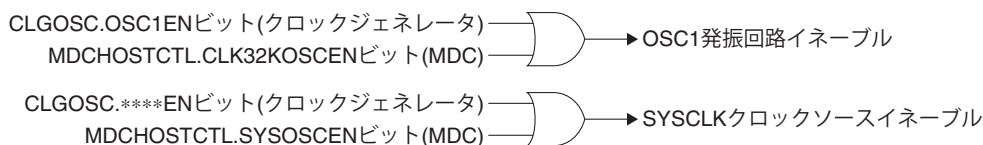
図23.3.4.1 発振回路の制御ロジック
