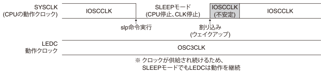
図2.3.4.3 SLEEPモード時のクロック制御例
