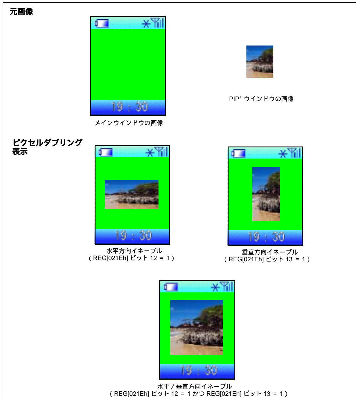
図13.16 ピクセルダブリングの例（PIP+ウィンドウ）
